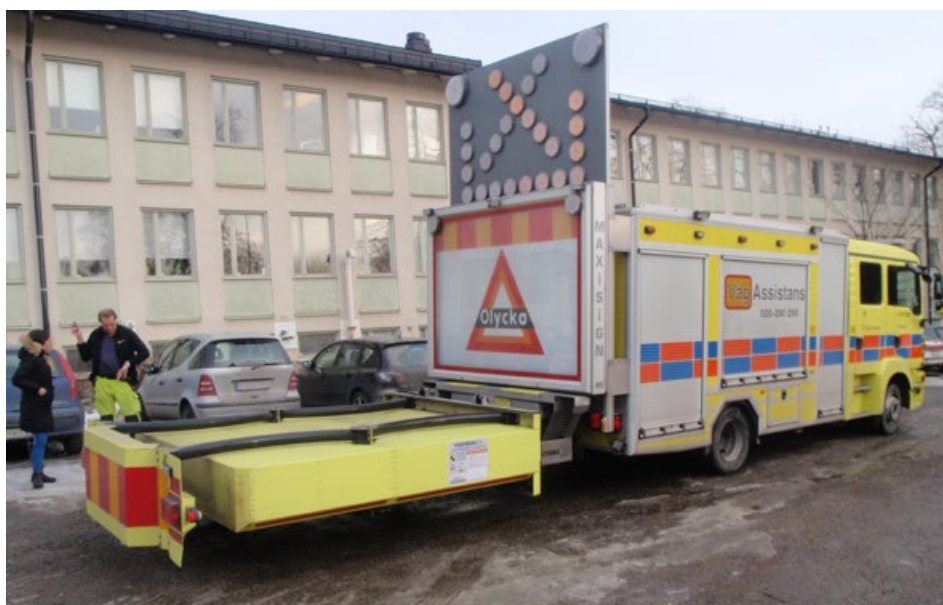
En av de nya VägAssistansbilarna från december 2011, med nymonterat TMS-skydd som är godkänt för påkörning med högre fart än 70 km/h.
